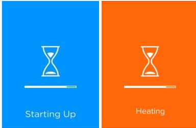
El LCI-777® está listo para la prueba de aliento típicamente en menos de 30 segundos. En frío extremo, el sistema debe calentar el sensor hasta una temperatura fijada. Esto puede llevar hasta 2 minutos. La temperatura del sensor y la boca son factores claves en la prueba de aliento por alcohol.
